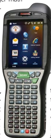
Dolphin 99EX fonctionne avec la technologie Adapter 6.0 pour la prise de photo et la lecture de codes à barres 2d
