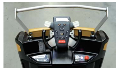
Le volant du NO 20 NE de Caterpillar (comme celui du PS20 de Rocla) s'inspire des manettes de jeux vidéos
